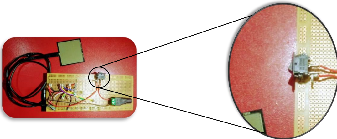
Ilustración 52. Switch de encendido y apagado del prototipo
