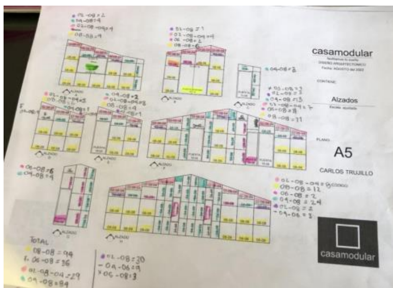
Ilustración 30. Cuantificación de obra manualmente plaquetas para la vivienda Carlos T
